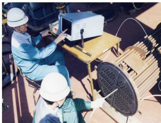
現場での探傷状況
