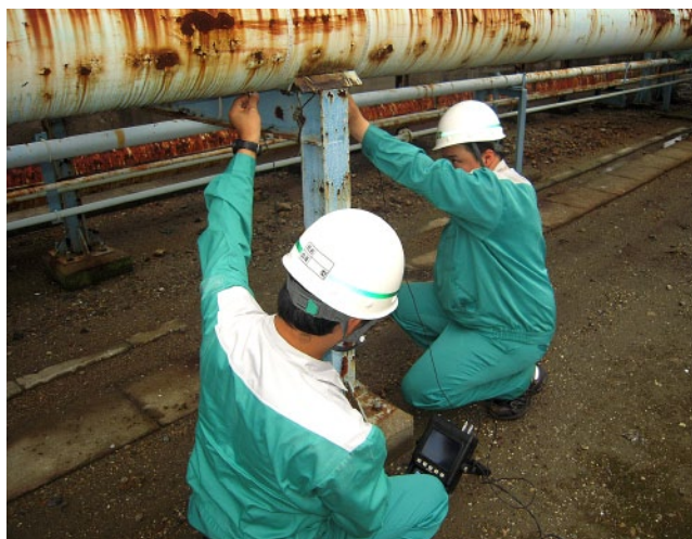
架台接触部の配管腐食調査状況
